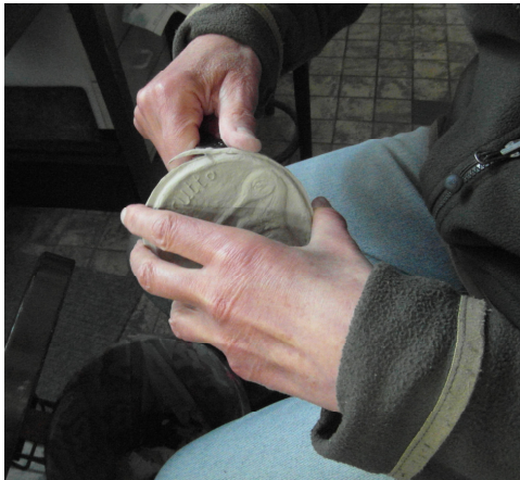
Das Ton-Modell wird zugeschnitten
